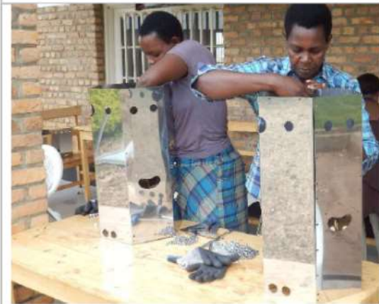
Bild 3: Finaler Zusammenbau der Save80-Öfen
