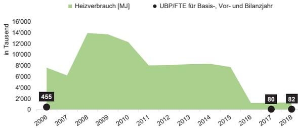
Der klimabereinigte Wärmeverbrauch ist gegenüber dem Vorjahr um 1.9% auf 2500 MJ/FTE und Jahr gestiegen. In gewissen Zonen musste die Raumtemperatur infolge Zugluft erhöht werden. Die Klima-Haustechnik wird diesbezüglich zur Zeit optimiert.
