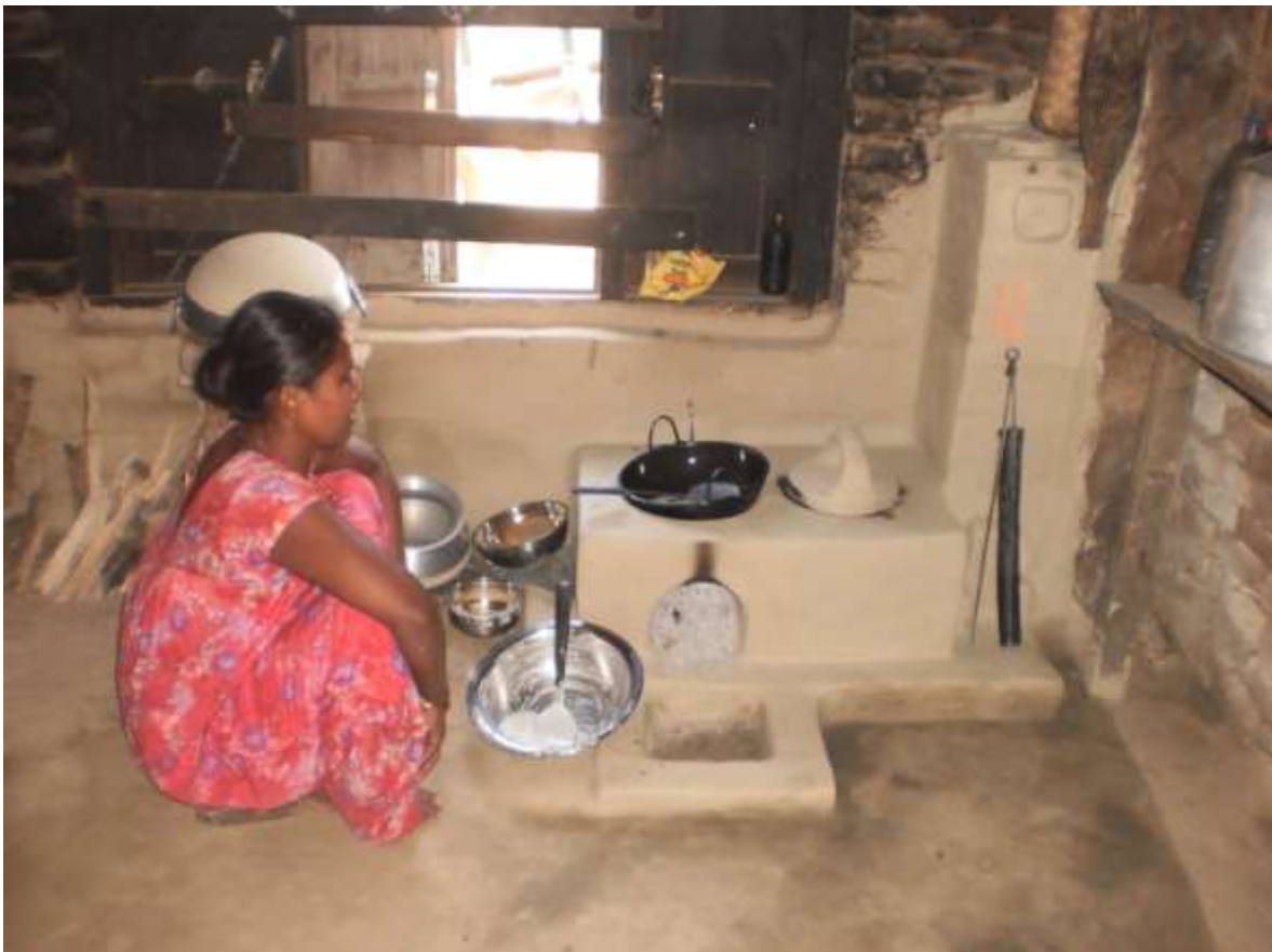
Ein Ofen aus Backsteinen ersetzt die offene Feuerstelle
