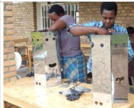
Bild 3: Finaler Zusammenbau der Save80-Öfen
